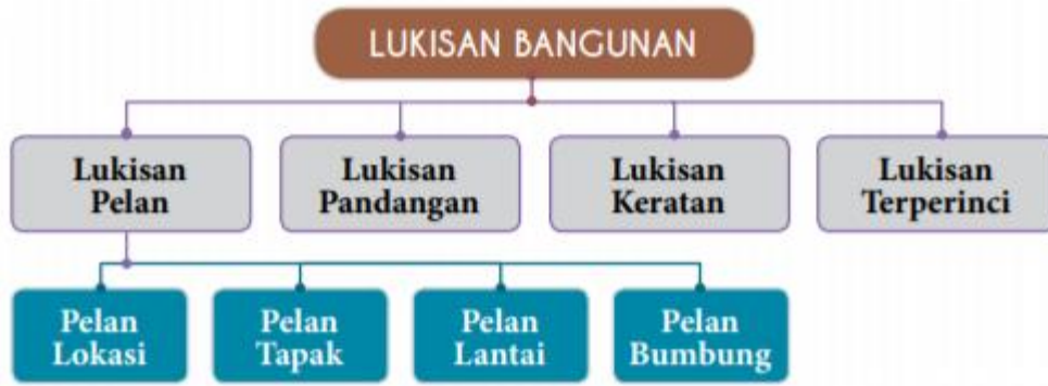
Rajah 4.1.2 Elemen dalam lukisan bangunan.
